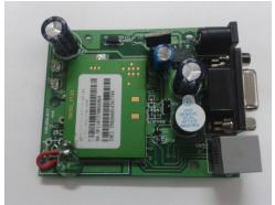
Fig. 7. GSM module
